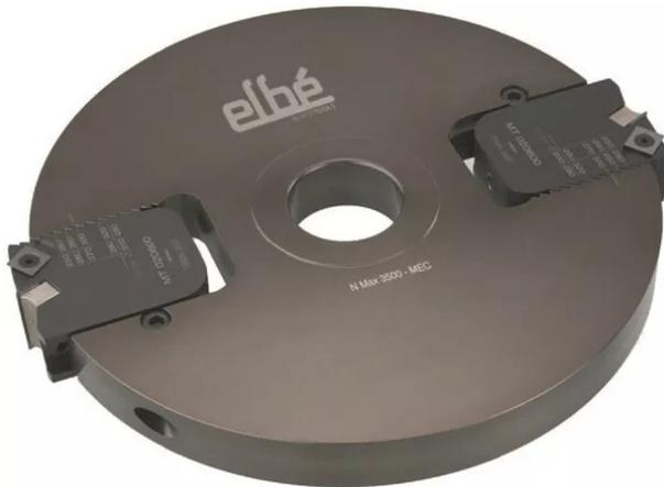
Corps en alliage léger. Plaquettes standards réversibles. Permet à partir d'un même corps, de réaliser indifféremment des opérations de contre-profilage et de tenonnage. Un système efficace et rapide de changement des têtes permet de modifier le diamètre de coupe de  $\varnothing$  280 à 320 mm.
