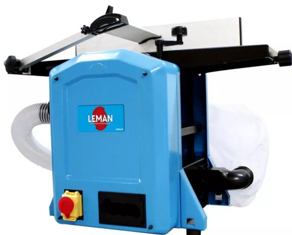
Machine transportable, idéale pour les chantiers et le travail sur site (charpentiers, poseurs, menuisiers). Système d'aspiration intégré avec sac de récupération des copeaux. Tiroir de rangement pour accessoires. Tables de dégauchissage rectifiées en fonte d'aluminium, avec lèvres anti-bruit. Table de rabotage en acier galvanisé. Guide de dégauchissage en profilé aluminium, inclinable jusqu'à 45°.
