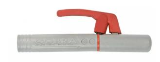
A levier. Pour des électrodes de ø 1,6 à 4 mm. Blocage de l'électrode par mâchoires laiton. Conforme à la norme EN 60974-11.
