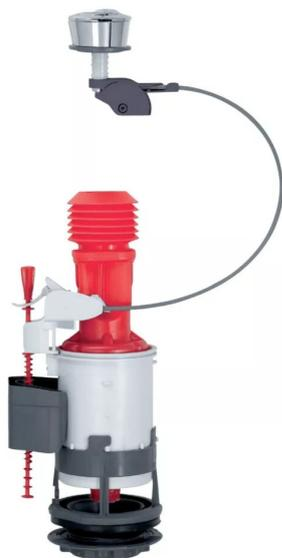
**Le mécanisme double chasse à câble MW2 est astucieux et prêt à l'emploi. Grâce à sa commande par câble, le mécanisme ne nécessite aucun réglage en hauteur et peut être installé rapidement. Le flotteur se déplace sur un axe vertical, et il est particulièrement adapté aux réservoirs étroits. Le système à double chasse 3 / 6L permet d'économiser de l'eau.**
