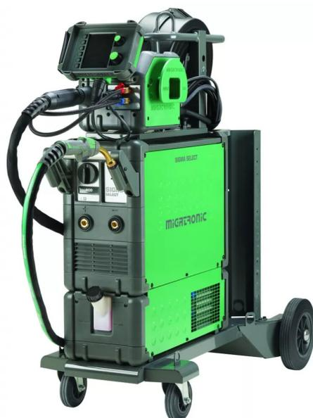
Poste à dévidoir externe avec refroidissement eau. Faisceau intermédiaire de 10 m. La version pulsée permet de souder sans émettre de projections, convient parfaitement à l'acier inoxydable et à l'aluminium. Le panneau de commande graphique intègre le mode Synergic ainsi que plus de 50 programmes de soudage.
