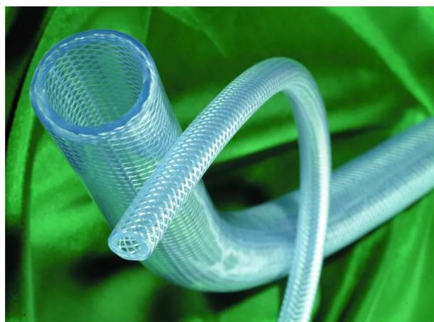
Tuyau souple polyvalent de qualité alimentaire en PVC renforcé par tresse textile haute ténacité. Température d'utilisation : -15°C à +60°C. PS (pression de service) à 23°C. PLNE (pression limite de non éclatement) à 23°C.
