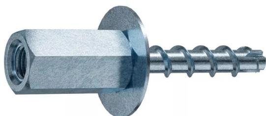
Ancrage autotaraudeur pour pierre béton, brique pleine et béton fissuré avec manchon femelle double filetage intérieur M8/M10 prémonté. Fixation rapide, sûre et étanche y compris près des bords du support. Manchon et rondelles démontables. Charge de traction élevée. Egalement certifiée pour dalles préfabriquées en béton alvéolaire précontraint et en zones sismiques.
