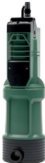
La pompe DIVERTRON est une pompe immergée entièrement automatique avec système électronique intégré qui commande l'arrêt et le démarrage de la pompe et la protège contre la marche à sec. Elle est adaptée au pompage d'eaux propres des réservoirs, des citernes et des puits. C'est la pompe idéale pour les systèmes de récupération d'eaux de pluie et les réseaux d'arrosage domestique. Alimentation 230 V. Débit maximale de 44,5 m<sup>3</sup>/h à niveau 0.
