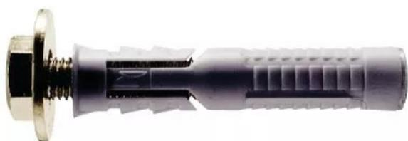
Cheville en nylon gris RAL 7035. Avec rondelle et écrou d'expansion acier M8 x 80. Domaines d'application : béton, pierre compacte, brique pleine, brique semi-pleine, brique creuse, béton cellulaire. Résistance à la charge : 220/100/80 daN (béton C20/25/brique creuse/CLS cellulaire).
