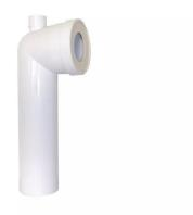
**Type** Longue avec prise d'air **Dimensions** Mâle - Ø 100 x L 350 mm - repiquage Ø 40 mm fem
