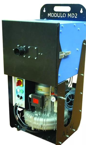
Turbine haute dépression intégrant un pré-filtre mécanique en entrée d'air. Prévue pour un rejet extérieur mais peut recevoir en complément un filtre fin polyester classe M pour le rejet intérieur (SCS 716). Marche/arrêt automatique par capteur de courant placé sur le câble de masse.
