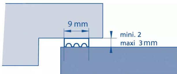
Permet de calfeutrer efficacement des espaces de 2 à 3 mm pour le joint K et des espaces de 3 à 5 mm pour le joint P. L'adhésif toilé renforcé assure une bonne fixation du produit. Facile à poser sur une surface lisse, propre et sèche. Les joints K et P sont des joints souples en caoutchouc cellulaire avec support adhésif armé pour une bonne fixation.
