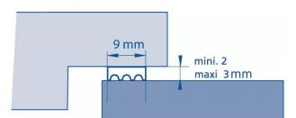
Permet de calfeutrer efficacement des espaces de 2 à 3 mm pour le joint K et des espaces de 3 à 5 mm pour le joint P. L'adhésif toilé renforcé assure une bonne fixation du produit. Facile à poser sur une surface lisse, propre et sèche. Les joints K et P sont des joints souples en caoutchouc cellulaire avec support adhésif armé pour une bonne fixation.
