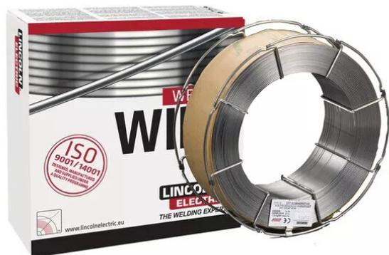
Fil fourré avec protection gazeuse pour un soudage de haute qualité en position à plat. Excellent choix pour répondre aux attentes des opérateurs grâce à des caractéristiques de soudage supérieures. Taux de dépôt important en position jusqu'à 3.2 kg/h. Excellentes caractéristiques mécaniques (CVN > 47J à -30°C) . Faible teneur en hydrogène diffusible (HDM < 5 ml/100 g). Excellent dévidage. Recommandé pour les passes de racine avec lattes céramiques.
