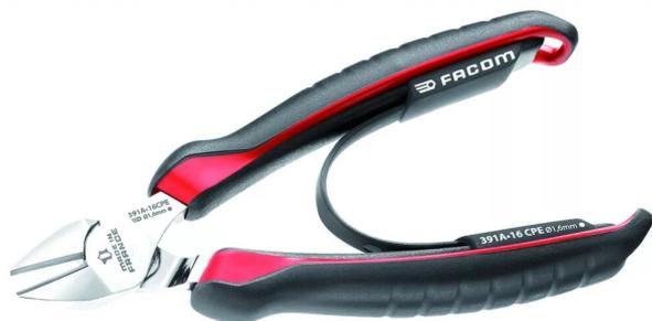
Bec effilé. Ressort de rappel amovible. Taillant conçu pour couper net tous les types de fils : corde à piano, fils durs et tendres (maxi. 200 kg/mm<sup>2</sup>). Gaines ergonomique en matériau très résistant aux produits chimiques. Bord coupant incliné avec surface plate pour fournir à la fois une durée de vie et une efficacité de coupe. Avantage mécanique grâce à la position du rivet et des mâchoires.
