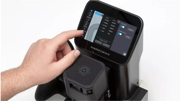
AutoPass définit la profondeur finale de fraisage et calcule automatiquement la profondeur de chaque passe en fonction de la fraise utilisée.
