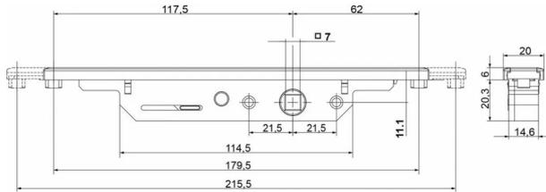
Mécanisme bidirectionnel, verrouillable par poignée à carré de 7, à monter dans la partie tubulaire du profil.
