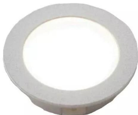
Spot led en aluminium avec diffuseur en polycarbonate opale, à encastrer ou à monter en applique avec bague de réhausse. Dimensions extérieure  $\varnothing$  64 mm, encastrement  $\varnothing$  58 mm, profondeur 12 mm. Kit livré complet avec transformateur et câble d'alimentation 2500 m.
