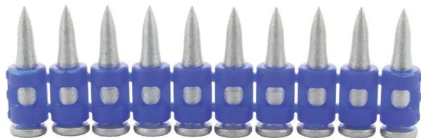
Clous Pulsa en acier carbone sur bande plastique bleue spécial béton très dur. Revêtement zingué 10 µm. Tête empreinte ø 6,4 mm. Tige longueur 17 ou 22 mm. Autonomie cartouche de gaz : 500 tirs. Domaines d'application : fixation de rails et goulottes sur pré-dalles, dalles alvéolaires.
