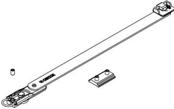
Accessoire utilisé pour limiter l'ouverture de l'ouvrant lorsque l'on se trouve à proximité d'obstacles comme des colonnes ou des murs.
