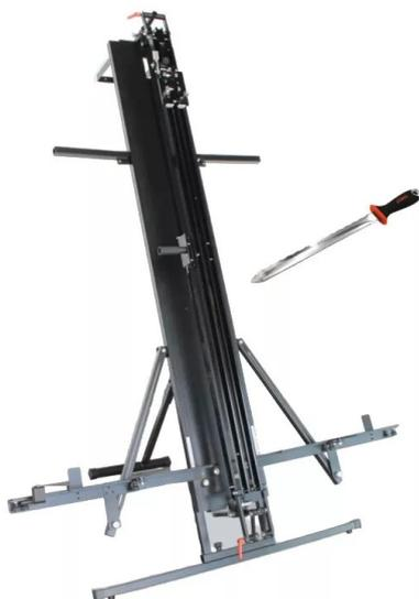
Gabarit de coupe robuste en aluminium pouvant accueillir divers modèles de scies électriques pour isolant. Deux règles de guidages latérales à angle réglable. Chariot de coupe coulissant sur guide pivotant réglable en profondeur. Epaisseur de coupe max 300 mm, hauteur de coupe max. 1350 mm (avec scie électrique). Domaines d'application : découpes rectangulaires, coudées, chanfreinées.
