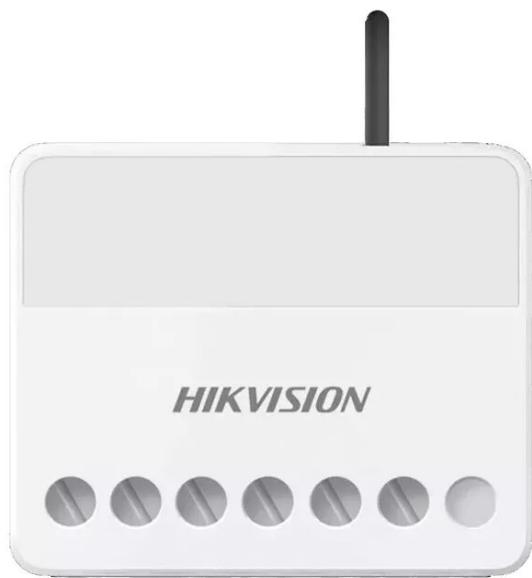
Module relais LED sans fil bidirectionnelle permettant de contrôler l'alimentation électrique à distance. Compatible avec centrales Hikvision AX Pro (fréquence 868 MHz). Petit et compact, il se dissimule facilement.
