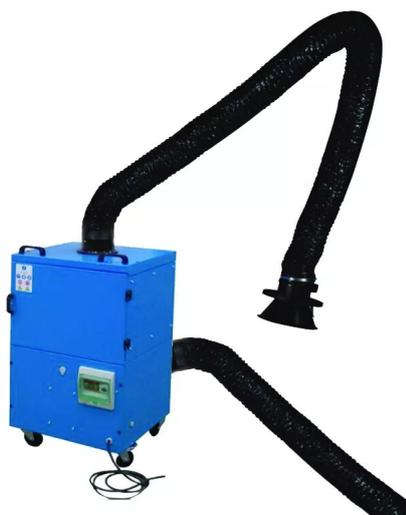
**ce type de dispositif ne filtre que les particules sèches solides non explosives. Il ne doit pas être utilisé en atmosphère confinée. Si son utilisation doit être permanente, préférez une solution à filtre fixe avec capteur ou bras fixe et évacuation hors du bâtiment.**
