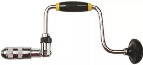
Mandrin universel à 4 mors avec logement pour mèches à queue carrée. Tête montée sur roulement à billes. Tête et poignée en matière synthétique.
