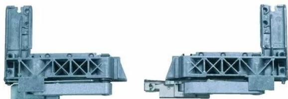
La fermeture oZ est sans fermeture progressive. A partir de la position d'ouverture en abattant, la fermeture du vantail est réalisée en poussant ce dernier dans le dormant. Le verrouillage s'effectue à l'aide de la poignée.
