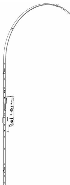
Le verrouillage s'effectue en quatre points, par relevage de la béquille, ce qui permet également de dégager la poignée pour ouvrir l'oculus. La condamnation du verrouillage est assurée par un cylindre de profil européen. Pêne 1/2 tour réversible.
