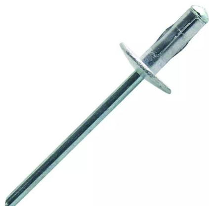
Le rivet multiserrage offre une grande capacité de serrage. Forte expansion du corps rendant la précision du diamètre de perçage moins importante. Bon serrage des pièces même si le rivet paraît trop long. Après sertissage, la tête de la tige est retenue augmentant ainsi sa résistance aux vibrations et son imperméabilité. Formant une large boule derrière les pièces assemblées, il est idéal pour les fixations sur des matériaux souples.
