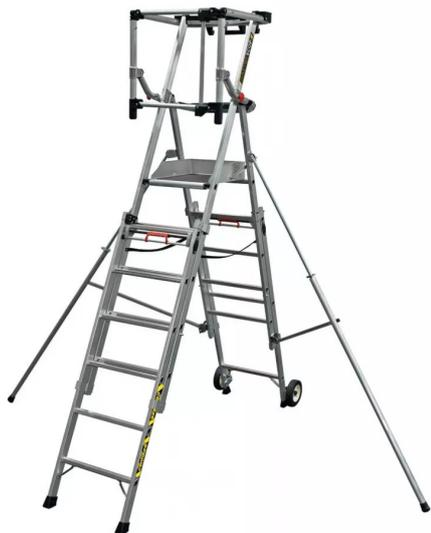
Réglage de la hauteur et verrouillage par poignées latérales, pratiques et ergonomiques. Tablette outillage et tablette peinture. Stabilisateurs à réglage millimétrique. Plancher et barreaux antidérapants. Protection de l'opérateur par garde-corps articulés  $\varnothing$  25 mm et chaînettes lisse et sous-lisse.  $\varnothing$  roues 200 mm. Charge maximale d'utilisation : 150 kg. Décret 2004-924. Normes : PIRL (PL SCOP 3/5), PIR (PL SCOP 4/7 et 6/9). Label NF.
