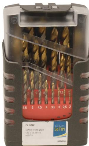
Revêtu TiN, 3 meplats (évite la rotation du mandrin). Fraisé et rectifié avec pointe étagée. Affûtage en croix. Perce les aciers jusqu'à 1000 N/mm<sup>2</sup>, l'aluminium, les matières plastiques (dont le polycarbonate fragile) et le bois.
