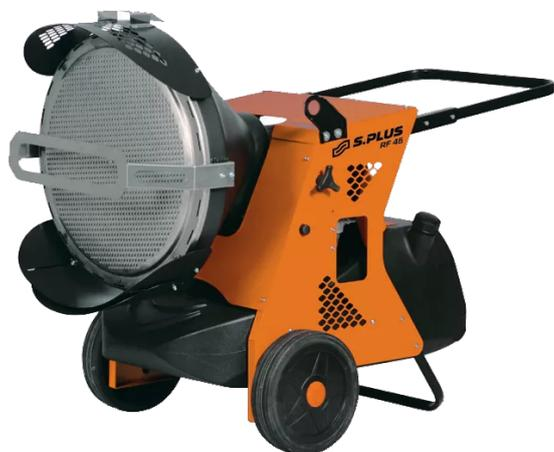
Emet un rayonnement infrarouge vers la zone à chauffer. La chaleur est dirigée là où elle est nécessaire. Appareil à combustion directe. Toutes les calories produites restent disponibles : rendement de 100 %. Brûleur fioul simple allure, prise thermostat pour TPF (option) ou minuteur (option), et contrôle de flamme par cellule photoélectrique. Réservoir intégré assurant de 10 à 16 heures d'utilisation (selon allure), 3 cônes concentriques ventilés (pas de réflecteur en fibre).
