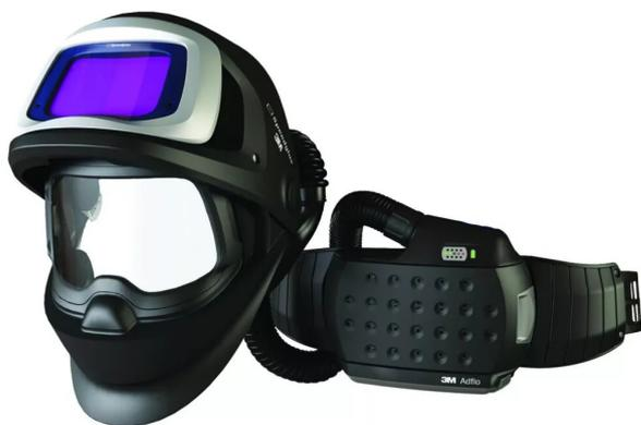
Filtre de soudage Speedglas 9100XX : teinte sombre variable 5, 8, 9-13 pour la plupart des procédés de soudage à l'arc. Il est possible de verrouiller toute teinte, par exemple dans l'état de lumière 3 au moment du meulage. Fonction de délai de réglage du temps d'ouverture sombre-clair. La sensibilité de la détection de l'arc peut être ajustée. La filtration Adflo vous protège efficacement contre les particules et les gaz.
