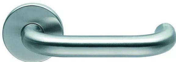
Carré 7 mm. Pour porte de 38 à 55 mm. ø 19 mm, avec rosaces béquilles rondes solidaires des béquilles, munies d'un ressort de rappel, avec sous-rosaces en métal. Fixation invisible des rosaces à l'aide de vis traversantes fournies. Montage des béquilles par vis pointeau sur carré fendu des deux côtés. NF EN 1906, utilisation classe 2, endurance classe 6.
