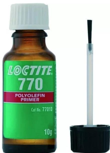
Le primaire Loctite 770 rend les polyoléfines et les autres matières de faible énergie de surface collables avec les adhésifs cyanoacrylates. Sur les surfaces ainsi traitées, les performances des adhésifs cyanoacrylates polymérisés sont comparables à celles décrites sur les fiches techniques des adhésifs respectifs.
