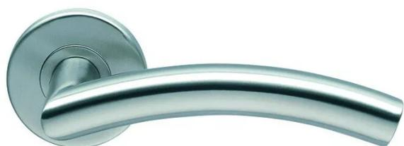
Carré 7 mm. Pour porte de 38 à 55 mm.  $\varnothing$  19 mm, avec rosaces béquilles rondes solidaires des béquilles, munies d'un ressort de rappel, avec sous-rosaces en métal. Fixation invisible des rosaces à l'aide de vis traversantes fournies. Montage des béquilles par vis pointeau sur carré fendu des deux côtés. NF EN 1906, utilisation classe 2, endurance classe 6.
