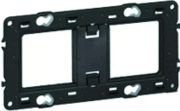
Supports pour fixation à vis. Livrés avec protection de chantier. Support bimatière pour rigidité renforcée. Equipées d'entretoises amovibles pour l'installation des fonctions étendues (ex : prises précâblées). Pour montage sur tous types de boîtes à vis.
