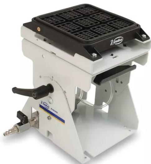
Système de serrage monté sur un support rabattable et rotatif. Manette de pivotement à 90° pour un travail ergonomique et efficace. Rotation à 360° avec dispositifs de blocage tous les 45°. Fixation sur la table grâce aux trous pré-perçés ou fixation temporaire sur plan de travail à l'aide du serre-joints fourni. Equipé d'une vanne pneumatique et d'un raccord rapide au circuit pneumatique. Livré avec 3 joints caoutchouc de différentes tailles.
