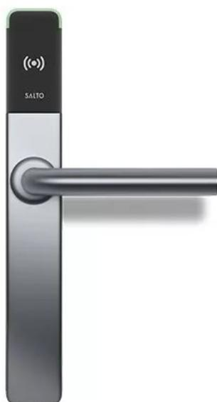
Système de fixation breveté de la béquille. Nouveau lecteur intégré. Technologie Mifare RFID sans contact avec détecteur de position de porte. Ensemble plaque béquille à poignée réversible gauche ou droite avec passage pour cylindre traversant (entraxe 70 mm), coté extérieur. Protection esthétique haute sécurité : plaque renforcées anti-perçage (protège le câblage et le lecteur) et vis de fixation cachées. Ouverture d'urgence par dispositif de programmation portable (PPD).
