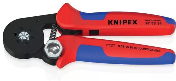
Sertissage hexagonal fiable des embouts de câble de 0,08 à 16 mm<sup>2</sup> en tournant et en réglant simplement la molette de réglage, et de tous les embouts de câble jumelés jusqu'à 2 x 10 mm<sup>2</sup>. Qualité de sertissage toujours élevée grâce au blocage forcé. Sertissage hexagonal pour petits embouts.
