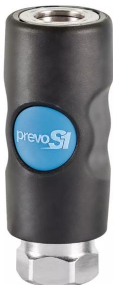
Situé en raccord d'implantation (alimentation de flexibles, distribution d'air comprimé sur postes fixes), le Prevo S1 évite "le coup de fouet" de l'embout au désaccouplement. Il assure la décompression et la déconnexion de vos systèmes et outils pneumatiques en une seule impulsion.
