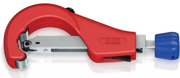
Le mécanisme QuickLock à ressort maintient l'outil sur le tuyau une fois verrouillé en place. Précis et rapide positionnement exact de la molette de coupe sur le tube. Les roulements à aiguilles de haute qualité permettent à la roue de coupe et aux quatre rouleaux de guidage de couper facilement. Epaisseur max. 2 mm.
