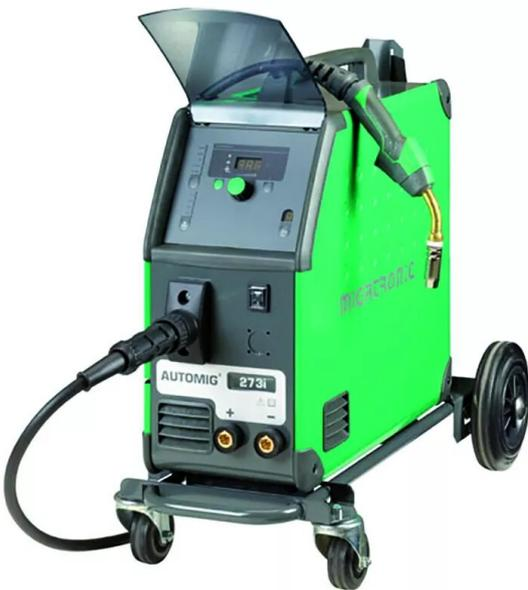
Machines conçues pour tous les matériaux et différentes applications de soudage. Panneaux de commande numériques et synergiques. Les machines Automig<sup>2</sup>i sont équipées d'un système de dévidage à quatre galets pour un dévidage stable et précis. L'Automig<sup>2</sup> 273i intègre la fonction de polarité inversée pour le soudage avec fils fourrés sans gaz (Innershield).
