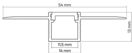
Conçu pour être installé entre les plaques de plâtre créant des lignes lumineuses.
