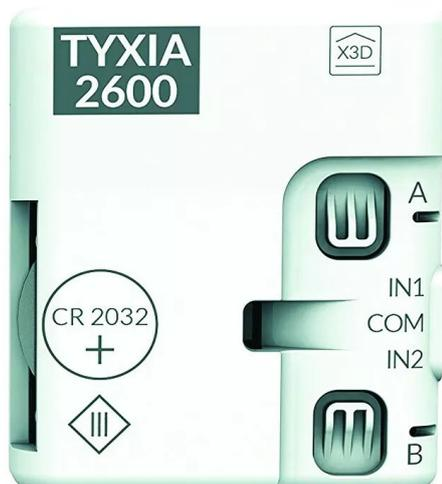
Fréquence radio 868 MHz - alimentation pile Lithium 3 V CR2032
